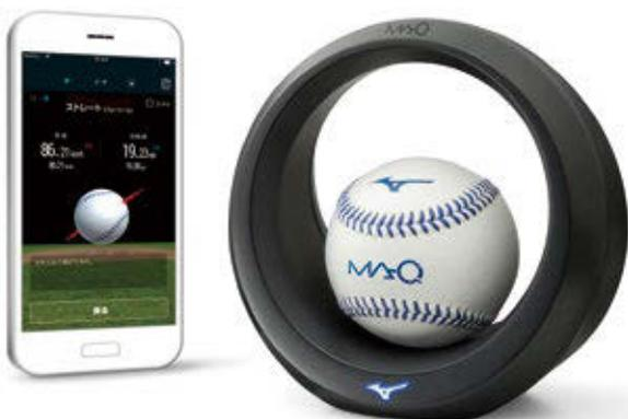
ミズノ株式会社の製品である野球ボール回転解析システム「MAQ (マキュー)」用のセンサモジュールを同社と共同開発しました。
