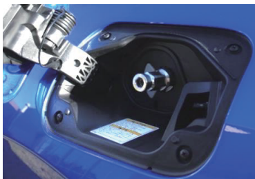
図 1 燃料電池自動車「MIRAI」の水素充填口 〔適用材料：AUS305-H2 (高圧水素用 SUS305) 冷間引抜材〕 2)
