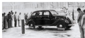
製鋼部で作成した部品を搭載したA1型試作乗用車
