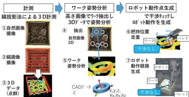
図16 計測からロボット動作点生成までの模式図
