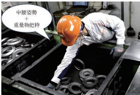
図1 リング鍛造品取出し作業
